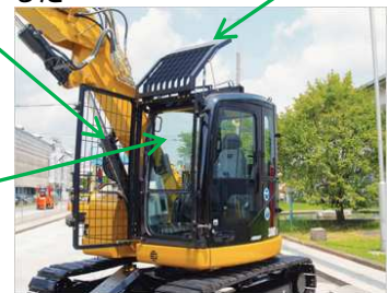
運転室周りの飛来物防護設備の例
